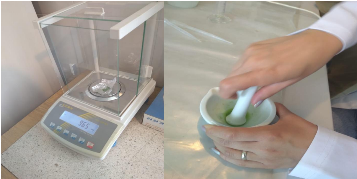
Foto 5, 6 Matja e mostrave në peshore analitike dhe përzirja e mostrës në havan porcelain
