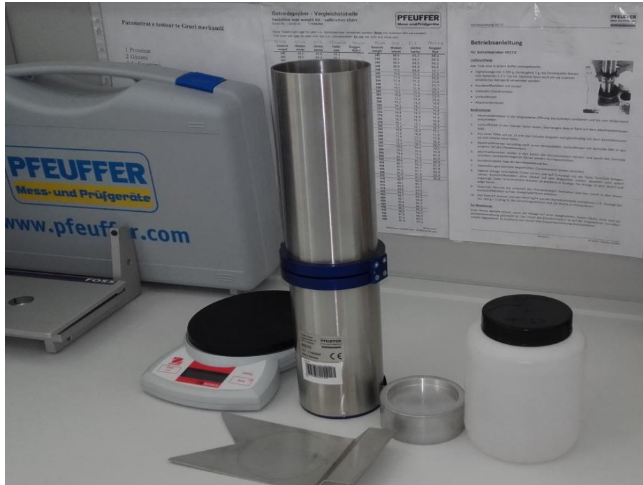
Fotografia 4. Aparaturë e peshës hektolitare (kg/hl), së bashku me peshoren e saj të përshtatshme për matje
