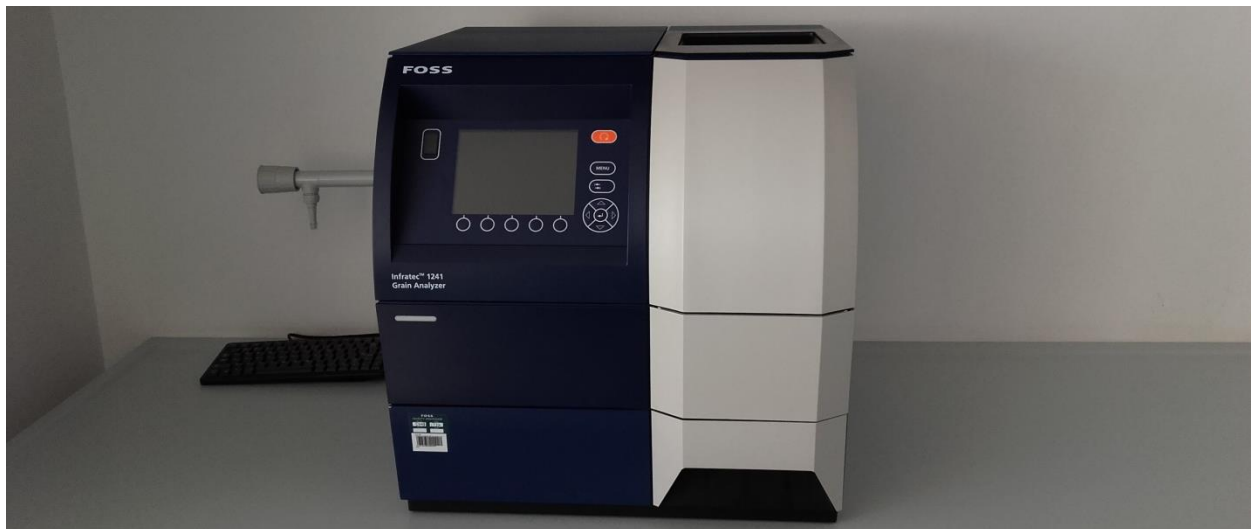
Fotografia 3. Aparaturë për kryerjen e analizave kimike në kokërr të drithërave (FOSS, Infratec™ 1241 Grain Analyzer)
