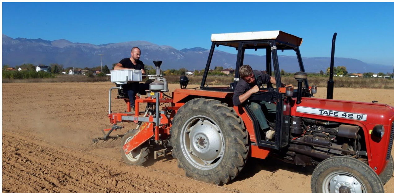
Fotografia 2. Mbjellja e fushave eksperimentale të elbit me makinë speciale, tipi Hege 80, Vitomericë /Pejë, Tetor 2019
